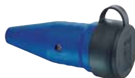
KUPPLUNG 16 A nach SEV 5934 Typ 23 mit Manschette und Verschlussdeckel spritzwassergeschützt IP44
