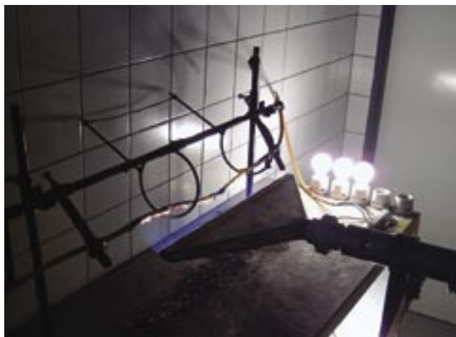
podle ČSN IEC 60331 - zkouška izolační integrity
