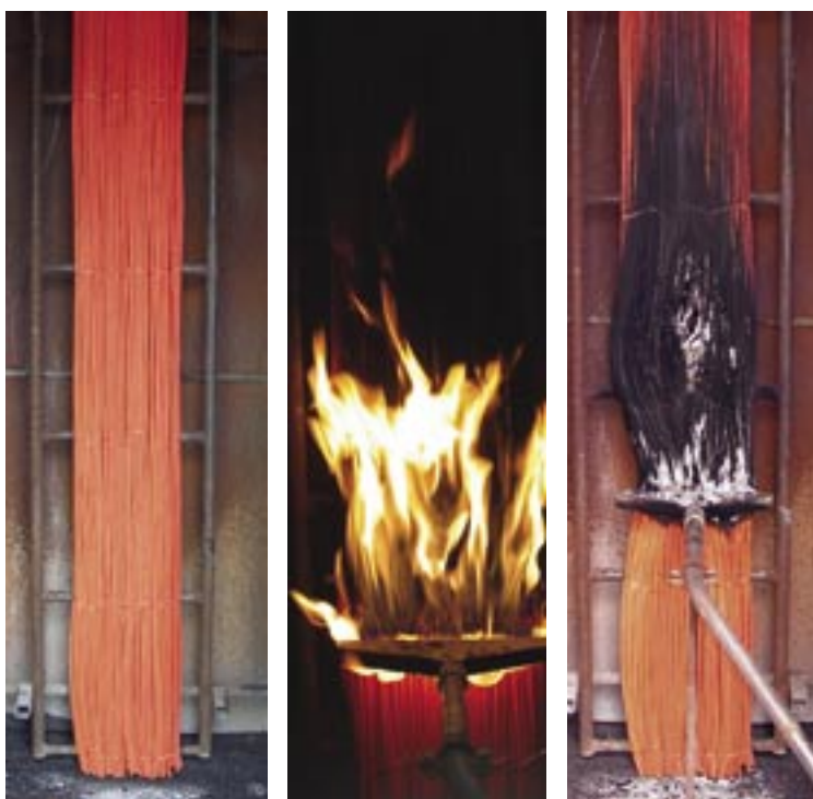
podle ČSN EN 50266 - zkoušky pro oheň nešířící kabely a vodiče
